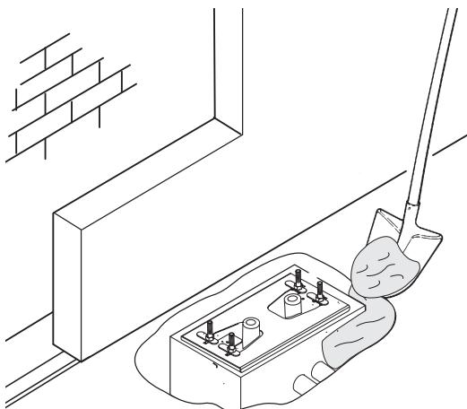
Отвинтите гайки и снимите их с винтов.
