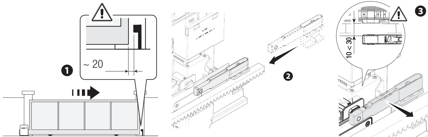
Прикрепите держатель к зубчатой рейке стопорными винтами (входят в комплект).
