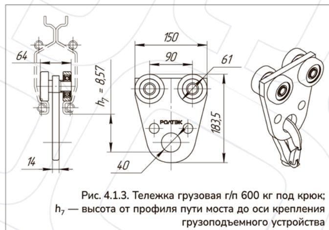
Рис. 4.1.3. Тележка грузовая г/п 600 кг под крюк;
