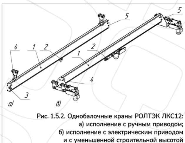
Рис. 1.5.2. Однобалочные краны РОЛТЭК ЛКС12:
