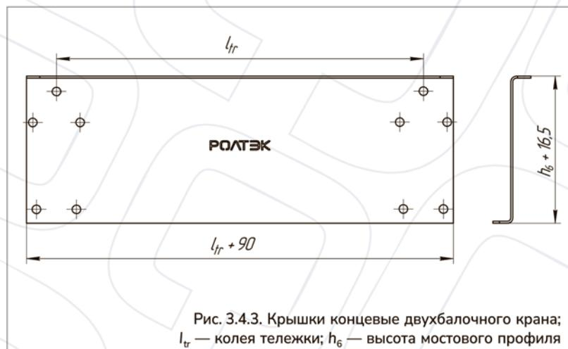
Рис. 3.4.3. Крышки концевые двухбалочного крана;
