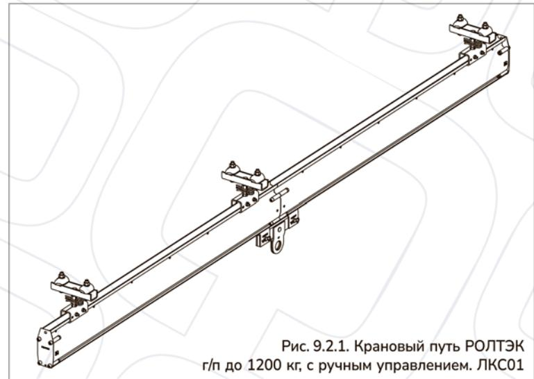
Рис. 9.2.1. Крановый путь РОЛТЭК г/п до 1200 кг, с ручным управлением. ЛКС01
