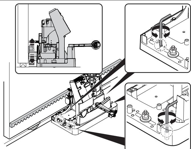
l - Передвинуть вручную створку, используя шестерню, как контрольную точку для закрепления других элементов зубчатой рейки
