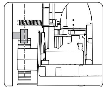
**07.** Плотно затяните гайки для крепления электропривода к фундаментной плите
