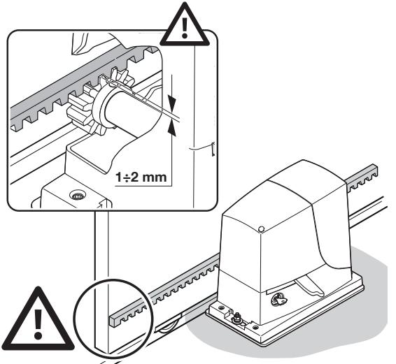
j - Проверьте правильность центрирования электропривода относительно створки ворот и зубчатой рейки
